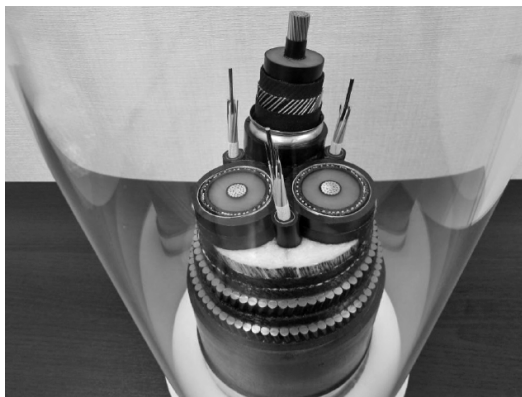
図 5 66kV ライザーケーブル
