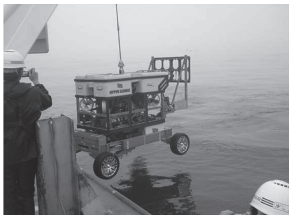
写真-13 ケーブル埋設仕様のROV投入状況
