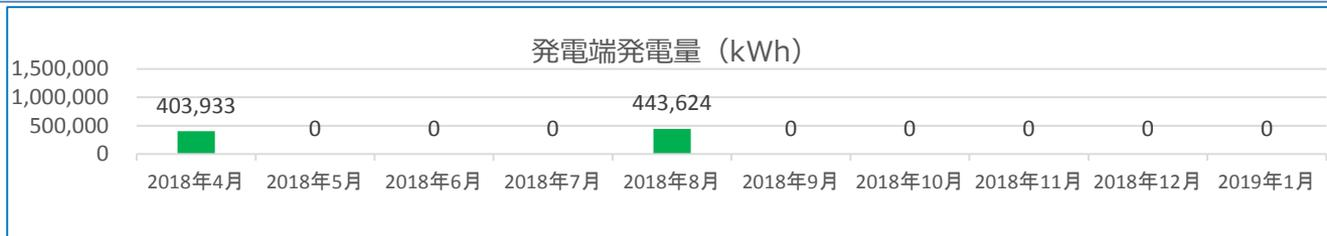
2018.5月から7月は、メンテナンスによる風力発電設備の発電運転の停止。(浮体の改修工事に伴う停止)
