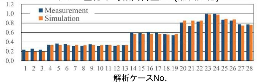
風況・海況を実測と合わせた解析の結果、荷重は概ね一致し、設計手法の妥当性を確認した。
